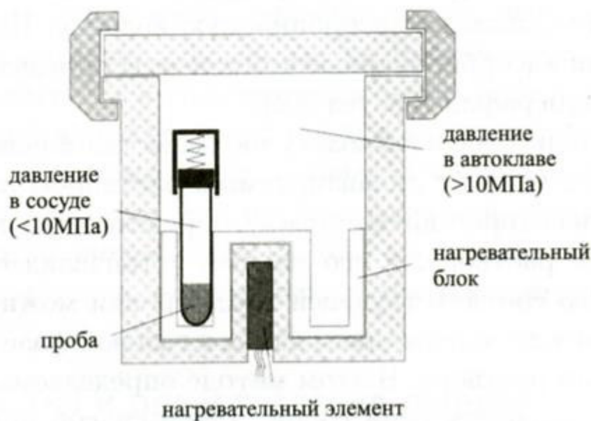
Рис. 1.8 Устройство Кнаппа для разложения пробы под давлением.
